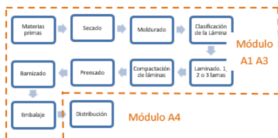
Ilustración 1. Esquema del proceso de fabricación
