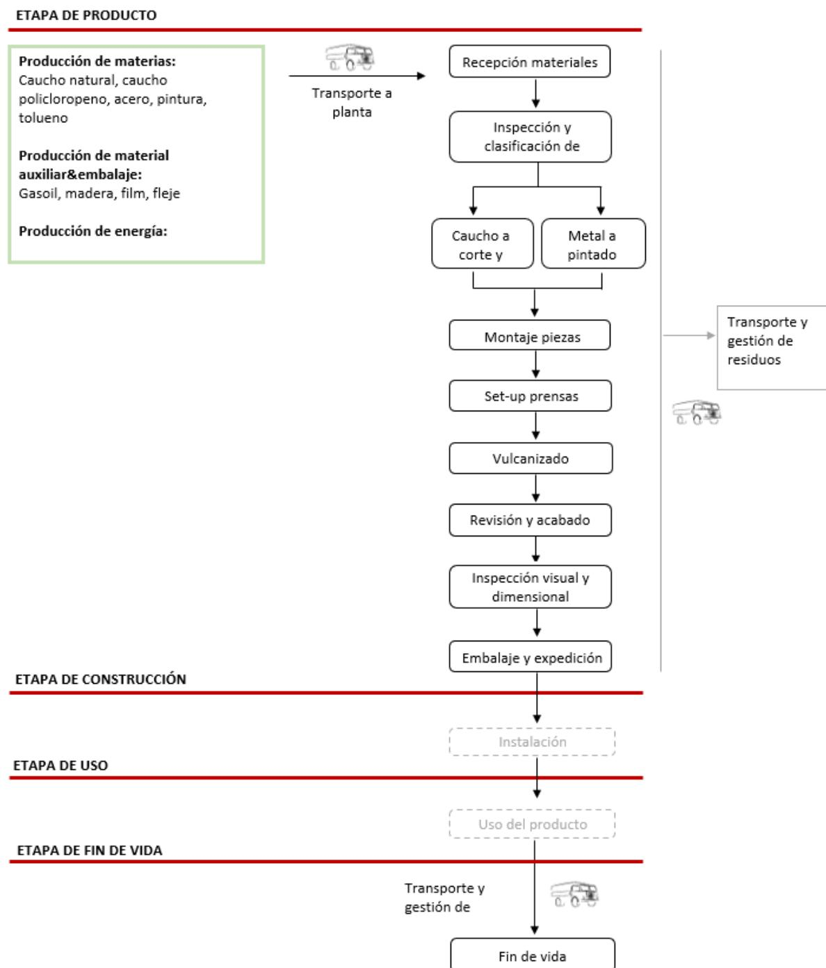
El proceso de fabricación comienza con el suministro de laminado de caucho en las instalaciones del fabricante. Tras recepcionar y verificar la mercancía en las instalaciones de CACESA, se realizan los procesos de fabricación de los apoyos.
