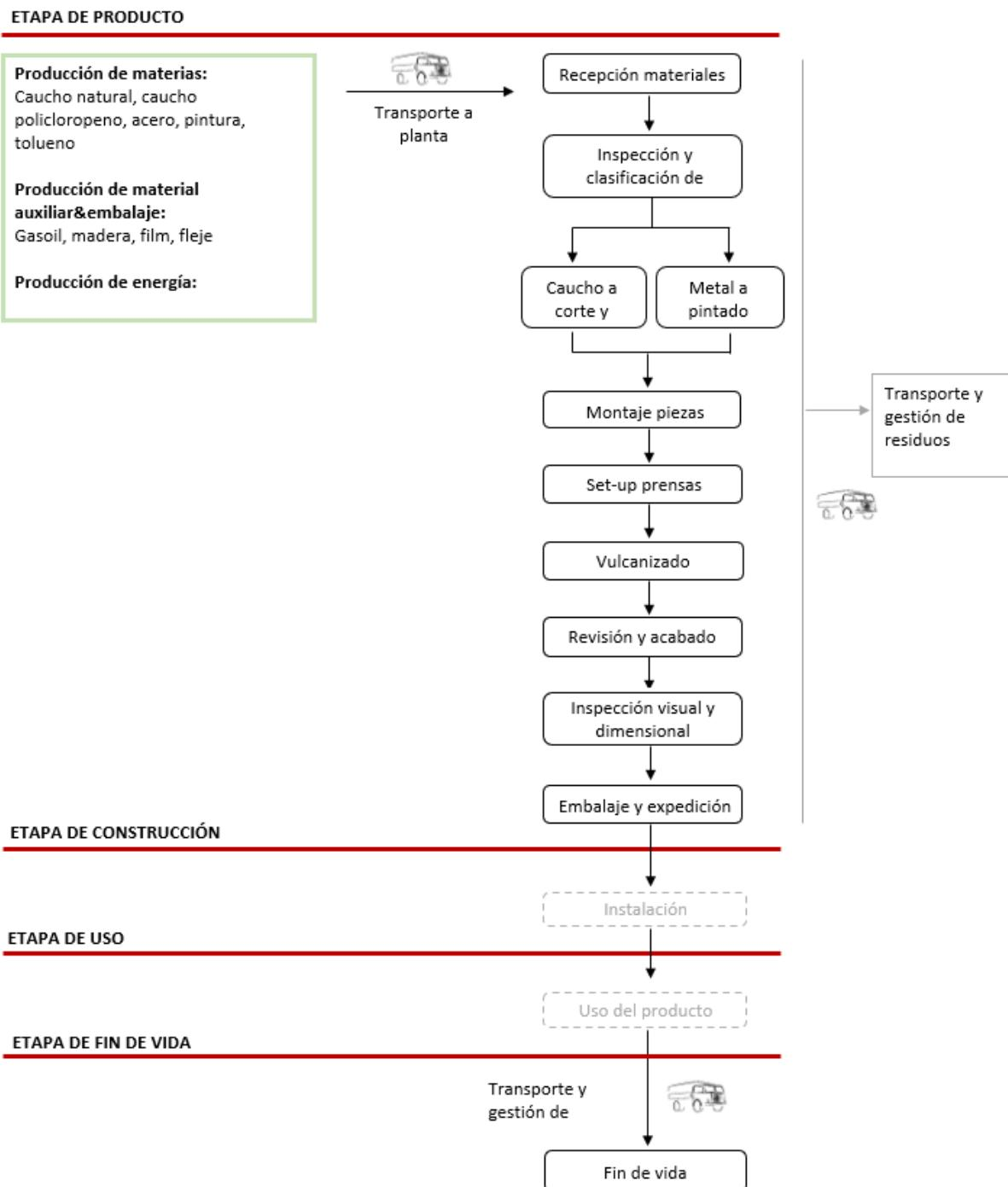
El proceso de fabricación comienza con el suministro de laminado de caucho en las instalaciones del fabricante. Tras receptionar y verificar la mercancía en las instalaciones de CACESA, se realizan los procesos de fabricación de los apoyos.
