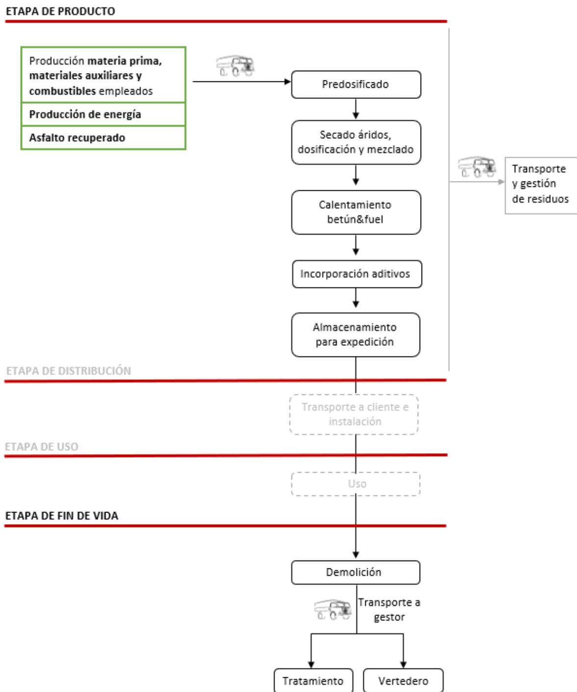
La fabricación de mezclas bituminosas tiene como objeto principal el mezclado de un ligante bituminoso con un conjunto de áridos de granulometría controlada.
