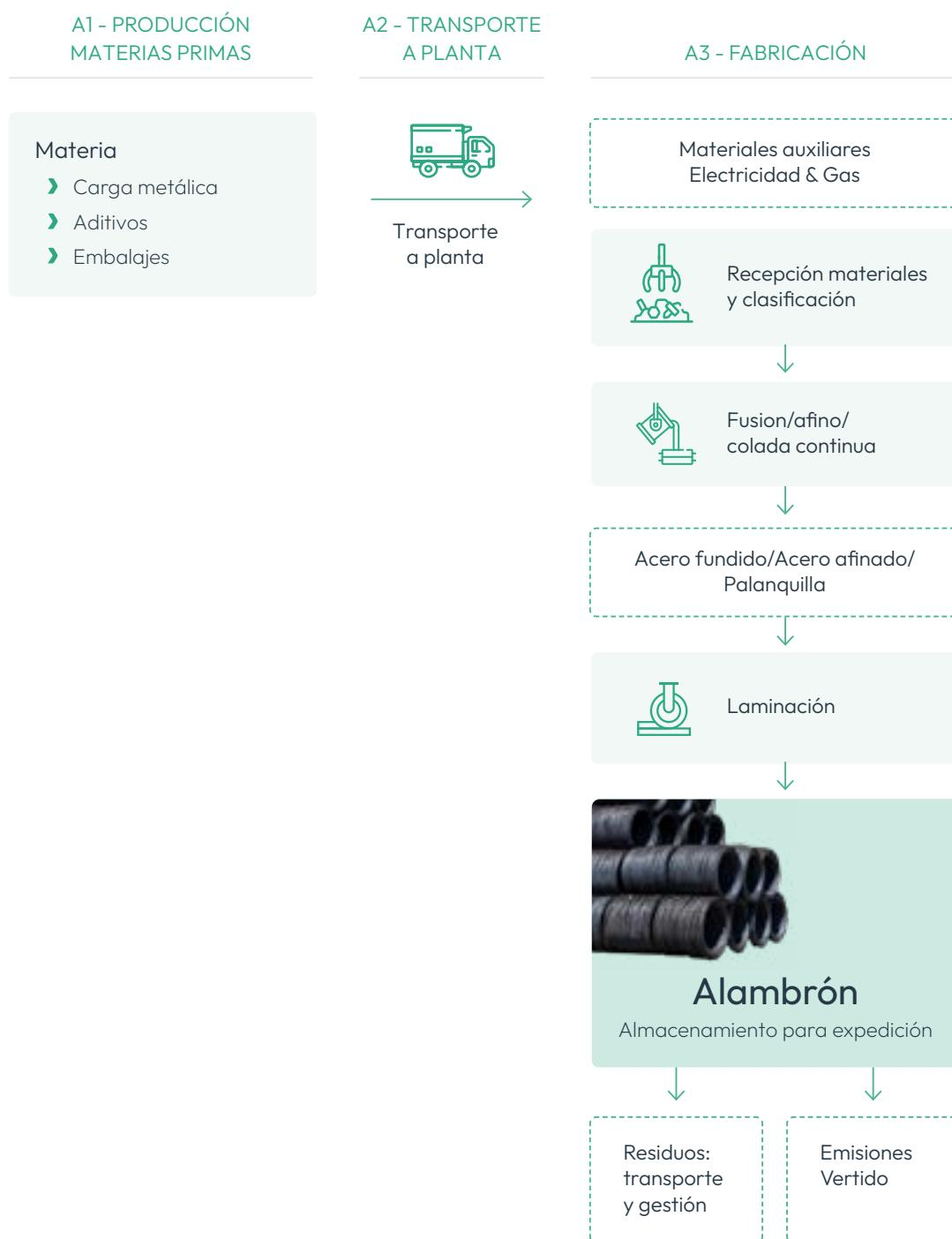
La fábrica produce acero mediante la ruta de horno de arco eléctrico. En la acería se funde principalmente chatarra metálica, proveyéndose al ajuste de la composición química para obtener las especificaciones requeridas del acero.
