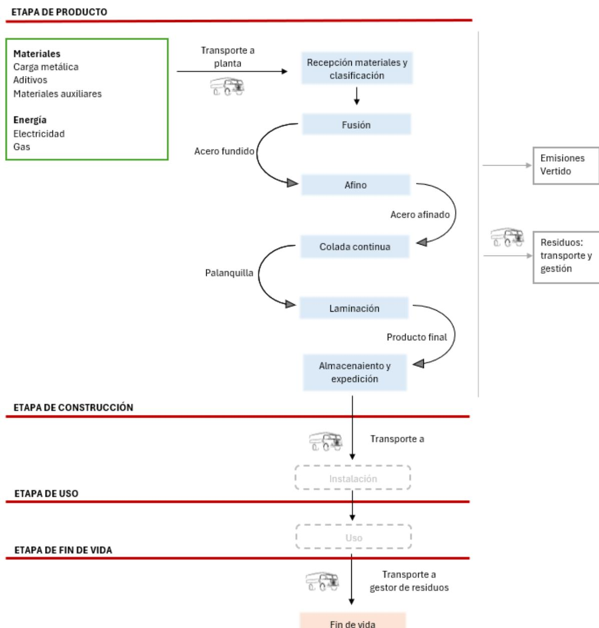
El proceso productivo se inicia con la acería, donde se obtiene el semiproducto (palanquillas, redondos, planchones o lingotes) con la calidad (composición química) necesaria para obtener el producto final. Este proceso se lleva a cabo a partir de la fusión de las materias primas en horno eléctrico de arco y se afina en horno de afino.
