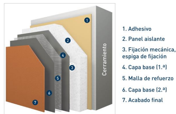
Figura 1. Configuración del sistema SATE estándar
