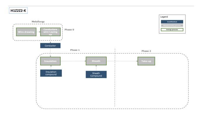
Diagrama de flujo del proceso de fabricación
